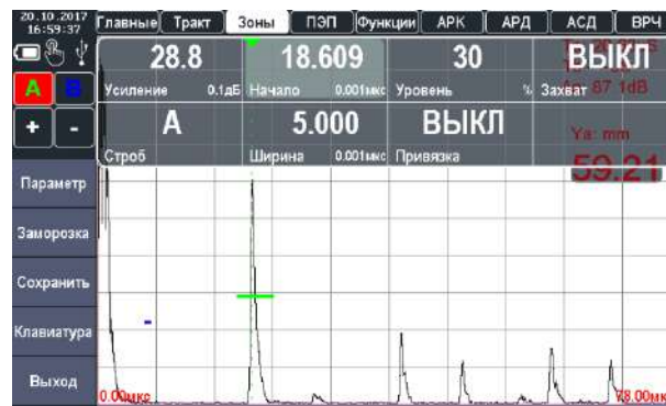
Рисунок 2.33 – Наведение строба А на сигнал от ближнего отражателя
