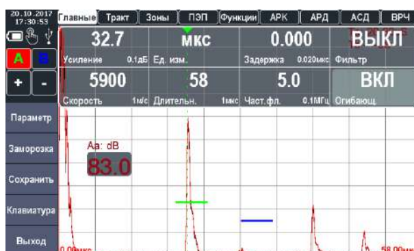
Рисунок 2.43 – Фиксация максимальной амплитуды сигнала в режиме огибающей
