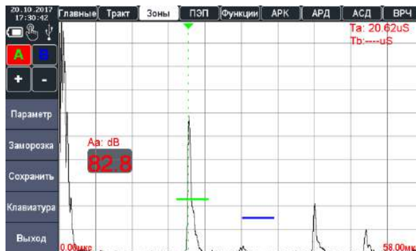
Рисунок 2.42 – Вывод значения амплитуды в зоне А
