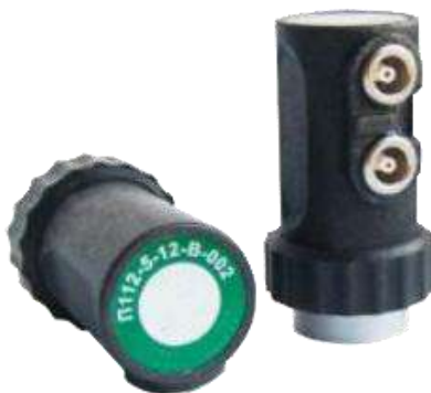
Рисунок 1.4 – Внешний вид прямого отдельно-совмещенного преобразователя
