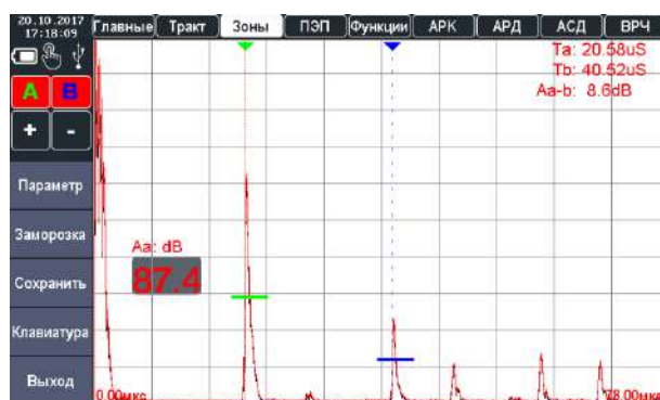
Рисунок 2.37 – Наведение строба В на второй отраженный сигнал
