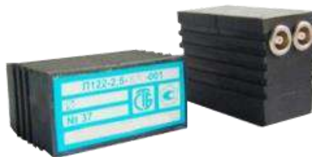
Рисунок 1.6 – Внешний вид наклонного раздельно-совмещенного преобразователя
