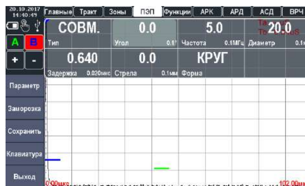
Рисунок 2.11 – Установка угла ввода УЗК
