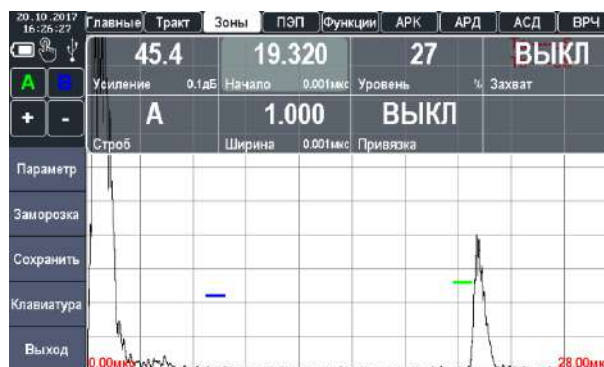
Рисунок 2.23 – Установка начала строба
