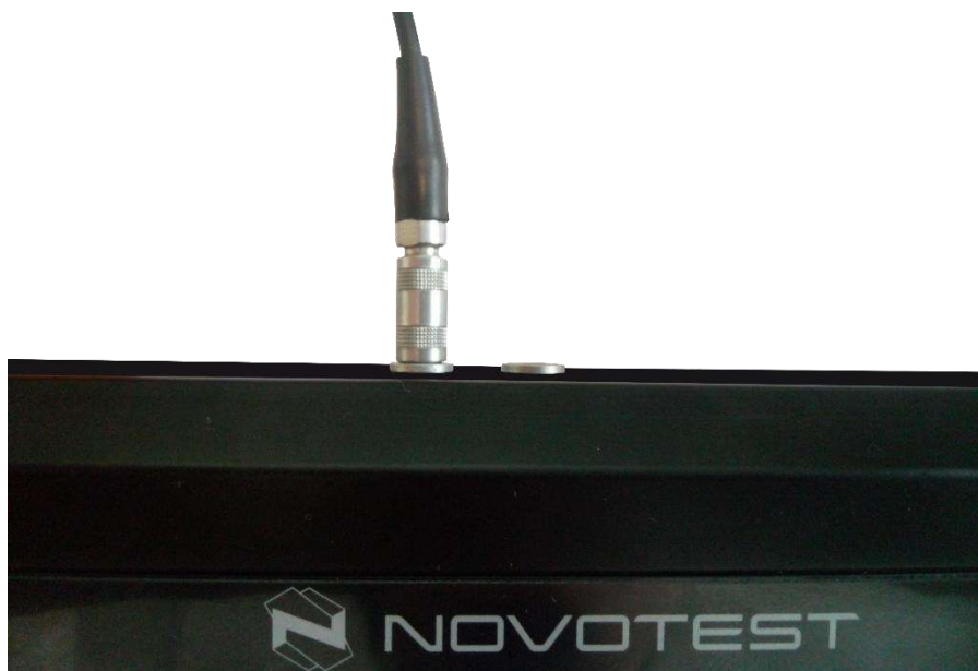
Рисунок 2.4 – Подключение совмещенного преобразователя к прибору
