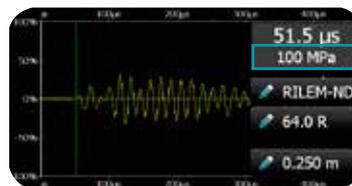
Определение прочности на сжатие ультразвуковым методом или методом SONREB (комбинированным).
