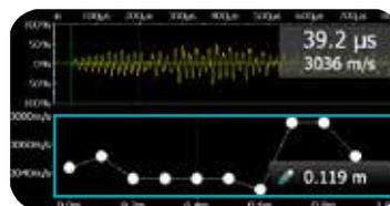
Оценивает однородность бетона и обнаруживает трещины и прочие дефекты. Измеренные скорости импульсов отображаются в виде линии.
